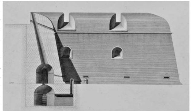
**Fig. 6.6 - Vista in sezione di un'opera bastionata con i sotterranei (De' Marchi L., Architettura militare. Illustrata da Luigi Marini, IV, Roma 1810).**
