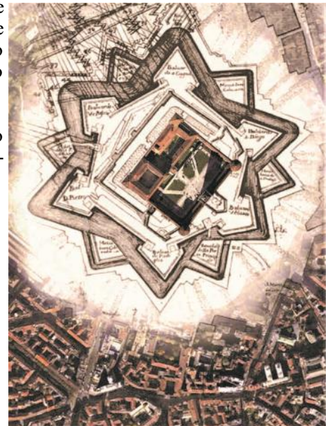
Fig. 15. Il Castello di Milano racchiuso nella bastionatura a pianta stellare con sei baluardi (bastioni) e altrettanti rivellini, nel corso di un assedio nel XVIII sec. (elaborazione grafica di Davide Padovan - Archivio Ass.ne S.C.A.M.).
