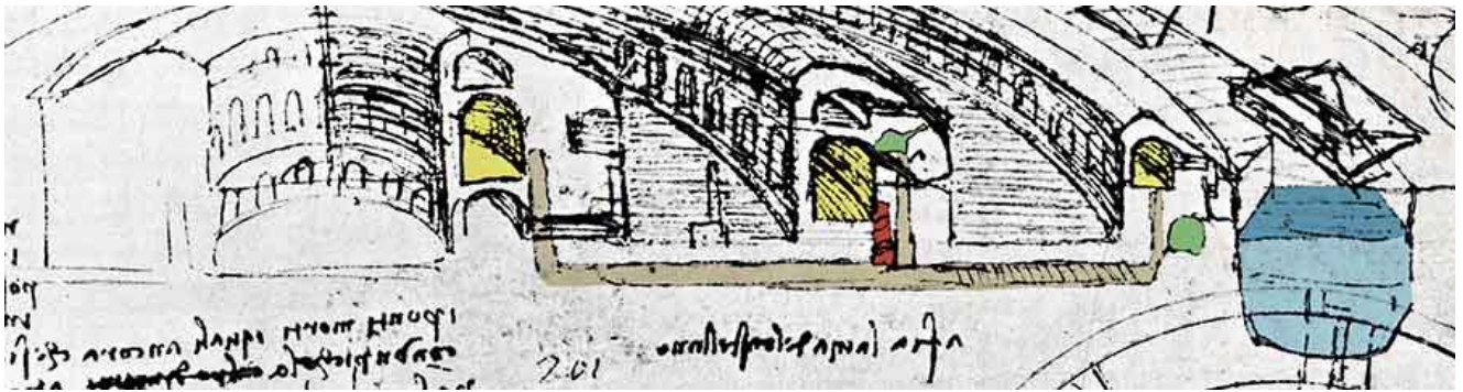
Fig. 10a. In colore grigio ho evidenziato la galleria sotterranea con i collegamenti agli ambienti principali (gialli) del primo e del terzo corpo di fabbrica, ma in quest'ultimo anche con un ambiente intermedio (verde); al centro la comunicazione con l'ambiente principale avviene attraverso una probabile scala a chiocciola ("scala di lumaca" come la chiama il Maestro, in rosso), mentre la comunicazione in colore grigio conduce a un ambiente superiore (verde) (Leonardo da Vinci, Codice Atlantico , f. 48 r.-a)
