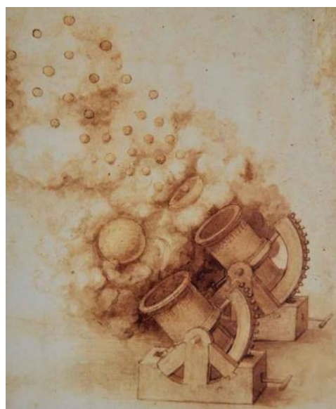
Fig. 2. Coppia di "bombarde" (Leonardo da Vinci, Codice Atlantico, f. 33 r.): il loro rinculo avrebbe piegato gli orecchioni e mandato in pezzi gli affusti. Analoghi pezzi d'artiglieria hanno certamente trovato impiego nel corso del tempo, ma montati su affusti particolari e atti ad assorbire il contraccolpo.
