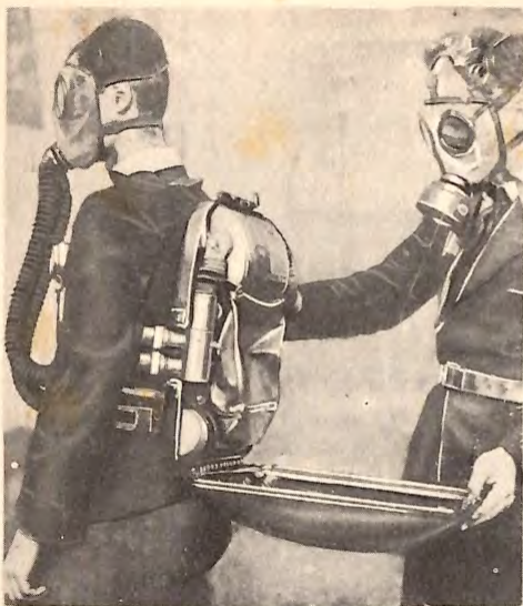
Un tipo di autoprotettore il cui rigeneratore di ossigeno è portato sulle spalle come uno zaino.
