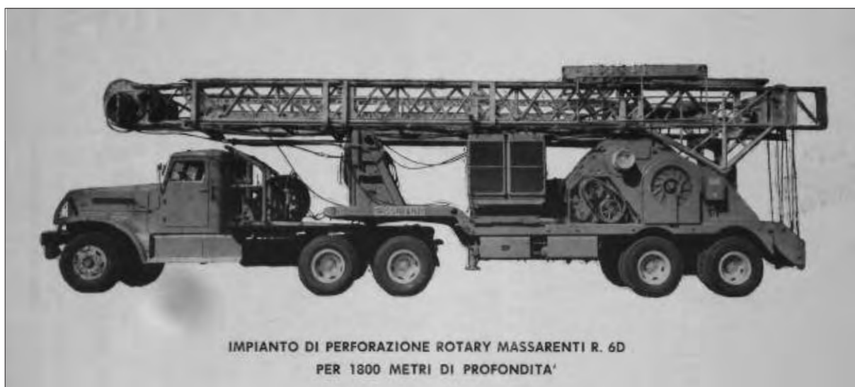
Fig. 1.7. Autoarticolato con impianto di perforazione Rotary Massarenti R. 6D per 1800 metri di profondità. (Tratta da: Desio A., Villa F., Stratigrafie dei pozzi per acqua della pianura lombarda. 1 – Lombardia, Università degli Studi di Milano – Istituto di Geologia, Milano 1960)
