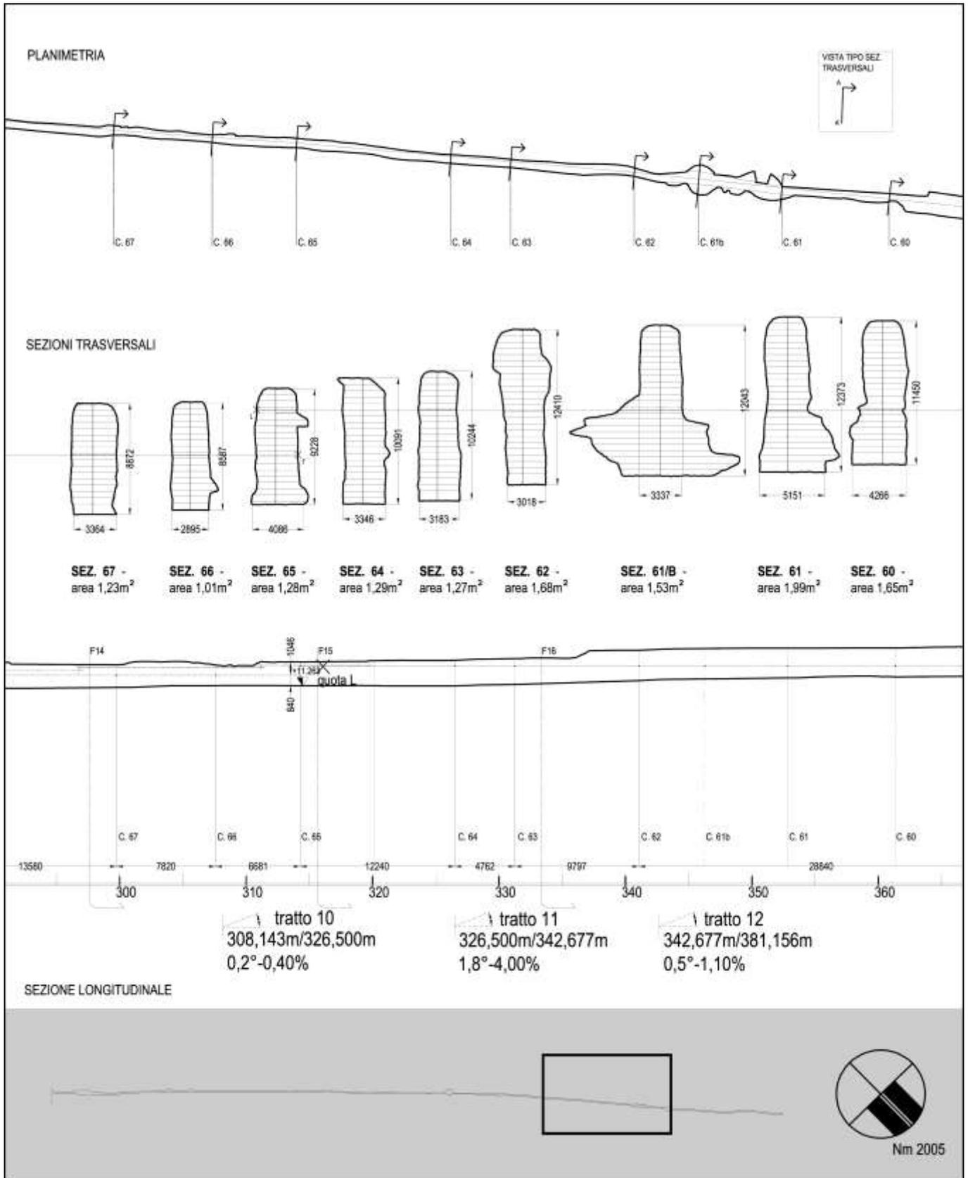
Fig. 11. Planimetria e sezioni dell'acquedotto.
