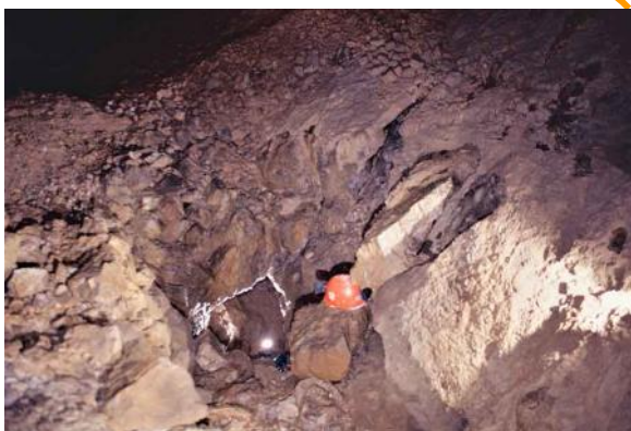
Fig. 1.27 - Grotta-miniera "Ferrera": l'immagine mostra l'accesso a un cantiere che si è sviluppato "a pozzo" e attorno si notano i muri a secco della ripiena, in questo caso utilizzati anche per il contenimento dello sterile più minuto, derivato dalla prima cernita nella vicina area di pesta.
