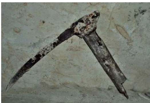
Fig. 1.44 - Piccone "da cava" utilizzato nella cava di Colma di Rosignano (Alessandria) per l'estrazione della Pietra da Cantoni.
