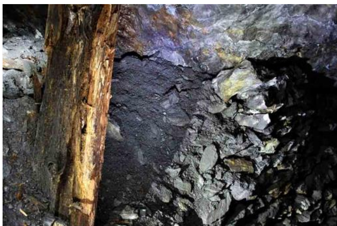
Fig. I.25 - Puntello ligneo e ripiena in una miniera di antracite abbandonata nel territorio di La Thuile (Valle d'Aosta).
