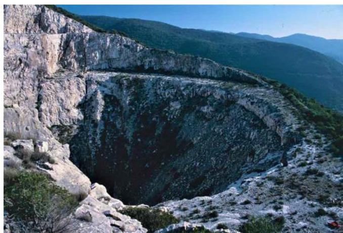
Fig. 1.15 - Grande cava di Monte Rombolo in Toscana, coltivata "a imbuto".
