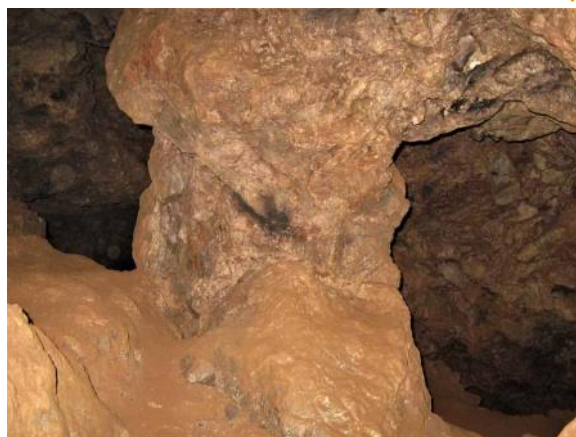
Fig. 1.20 - Miniera d'epoca preindustriale: la massa mineralizzata d'idrossidi di ferro è stata quasi completamente asportata, ma lasciando un pilastro a garantire la stabilità della volta.
