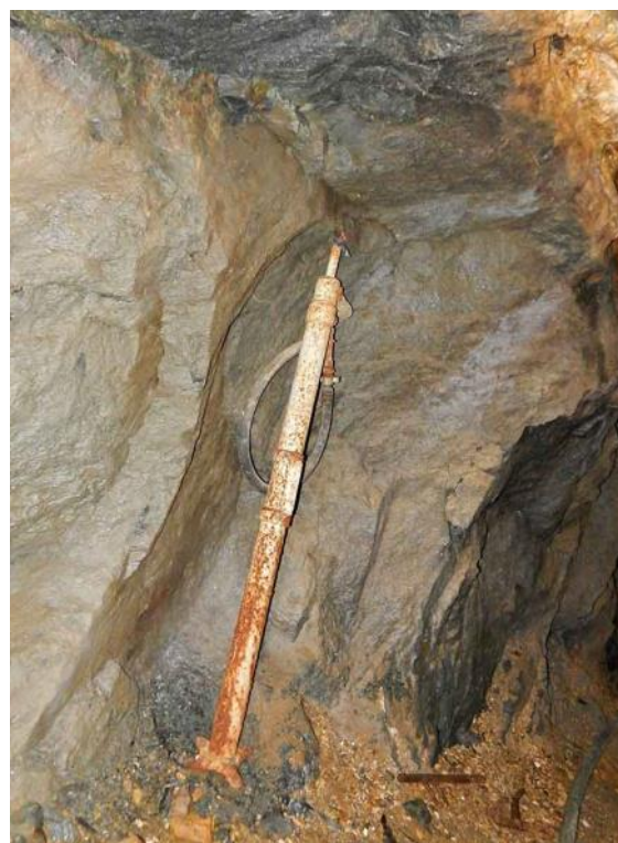
Fig. 1.69 - Sopperto per un martello pneumatico abbandonato lungo una galleria di carreggio a Brusson (Valle d'Aosta).
