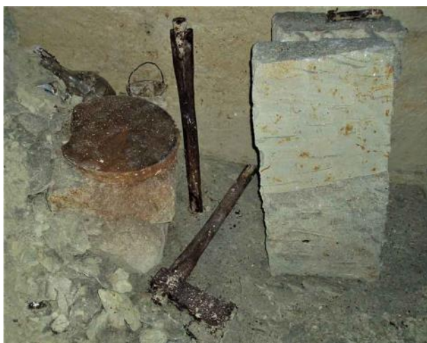
Fig. 1.45 - Strumenti per sbazzare i conci nella cava di Colma di Rosignano (Alessandria) e altro materiale abbandonato dai cavaatori.
