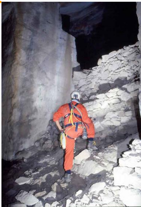
Fig. I.24 - Viggiù (Varese): cava sotterranea di calcare; la coltivazione è principiata “a pilastri abbandonati”, ma in seguito, e verosimilmente dopo un lungo periodo di abbandono, è ripresa anche con “pilastri artificiali”. Difatti i pilastri erano stati in parte “sgrassati” al punto tale da dover essere rinforzati con murature che hanno impiegato gli scarti di estrazione. Nella foto si possono notare un pilastro della coltivazione e le ripiene che vanno a tracciare e sostenere la viabilità interna.
