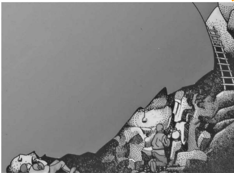
Fig. 1.35 - Raffigurazione di una cava di pietra ollare sotterranea denominata localmente "trona", formatasi con l'approfondimento dell'estrazione principiata "a giorno". In linea generale l'utilizzo della pietra ollare risalirebbe almeno al IV-III sec. a. (da un pannello didattico).
