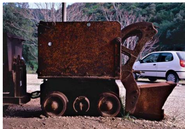
Fig. 1.11 - Particolare vagoncino da miniera con sistema per prelevare e sollevare il materiale estratto.
