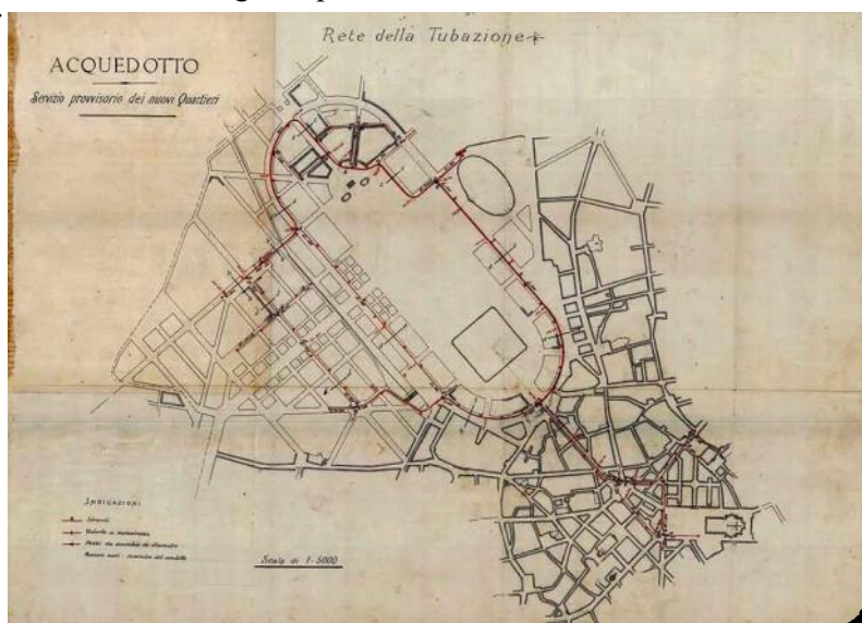
Fig. 29. Planimetria del 1888: «Rete delle Tubazione - Acquedotto - Servizio provvisorio dei nuovi Quartieri» (Cittadella degli Archivi e Archivio Civico Milano).
