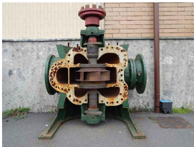
Fig. 101. Didattica: pompa di spinta in rete del 1969, la cui portata era di 400 l/s, anch'essa oggi esposta presso la Centrale di pompaggio Padova.
