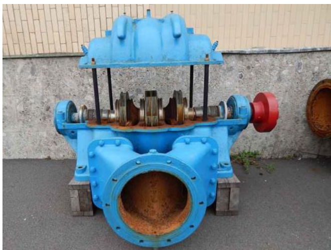
Fig. 100. Didattica: pompa di spinta in rete degli anni '60 del XX secolo, la cui portata era di 250 l/s, esposta presso la Centrale di pompaggio Padova.
